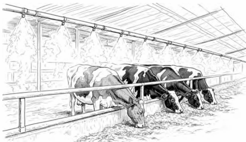
Рис. 3. Приклад використання туманоутворення у приміщенні для корів полегшеного типу у період теплового стресу (створено автором з використанням ШІ)
