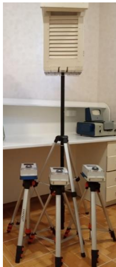
Рис. Зовнішній вигляд вимірювальної системи АПСЕ-М, укомплектованої метеорологічною будкою та штативами для тримання на висоту розміщення тварин.
